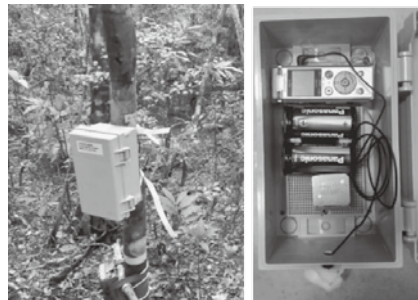
図1. 自動録音機の外見(左)と中身(右)。中身は防水のため、実際には機器をシリカゲル入りのジッパー付ポリ袋に保存した。
